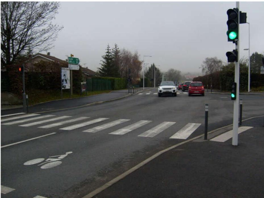
Figure 7: Vue du carrefour et du passage piéton. Nous proposons des pictos vélos en parallèle au passage piéton, dans un seul sens, indiquant aux cyclistes de traverser vers l'autre côté de la rue. On peut aussi mettre un panneau «tourner à droite vélo» sur le feu, pour les cycliste qui souhaitent prendre la route de Divonne.
