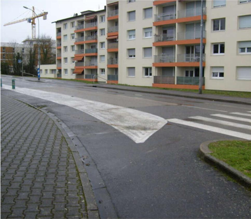
*Figure 6: Ici, il est important que les cyclistes qui continuent vers l'avenue de Vessy comprennent qu'ils doivent traverser la route pour prendre la bande cyclable qui se trouve de l'autre côté. On voit trop souvent des enfants circulants sur la bande cyclable dans le mauvais sens, et avec les bus nombreux, le risque est important ! Nous proposons de mettre une flèche indiquant qu'il faut traverser, et des pictos vélos en parallèle au passage*
