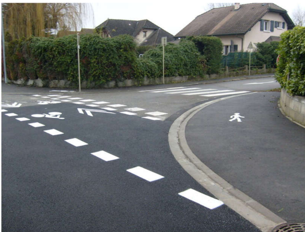
Figure 17: Plus loin, le marquage permet de comprendre qu'après l'intersection, certains trottoirs sont réservés aux piétons, et que le cycles ne peuvent rester que sur l'un d'eux. C'est clair, c'est un bon exemple à reproduire ailleurs.
