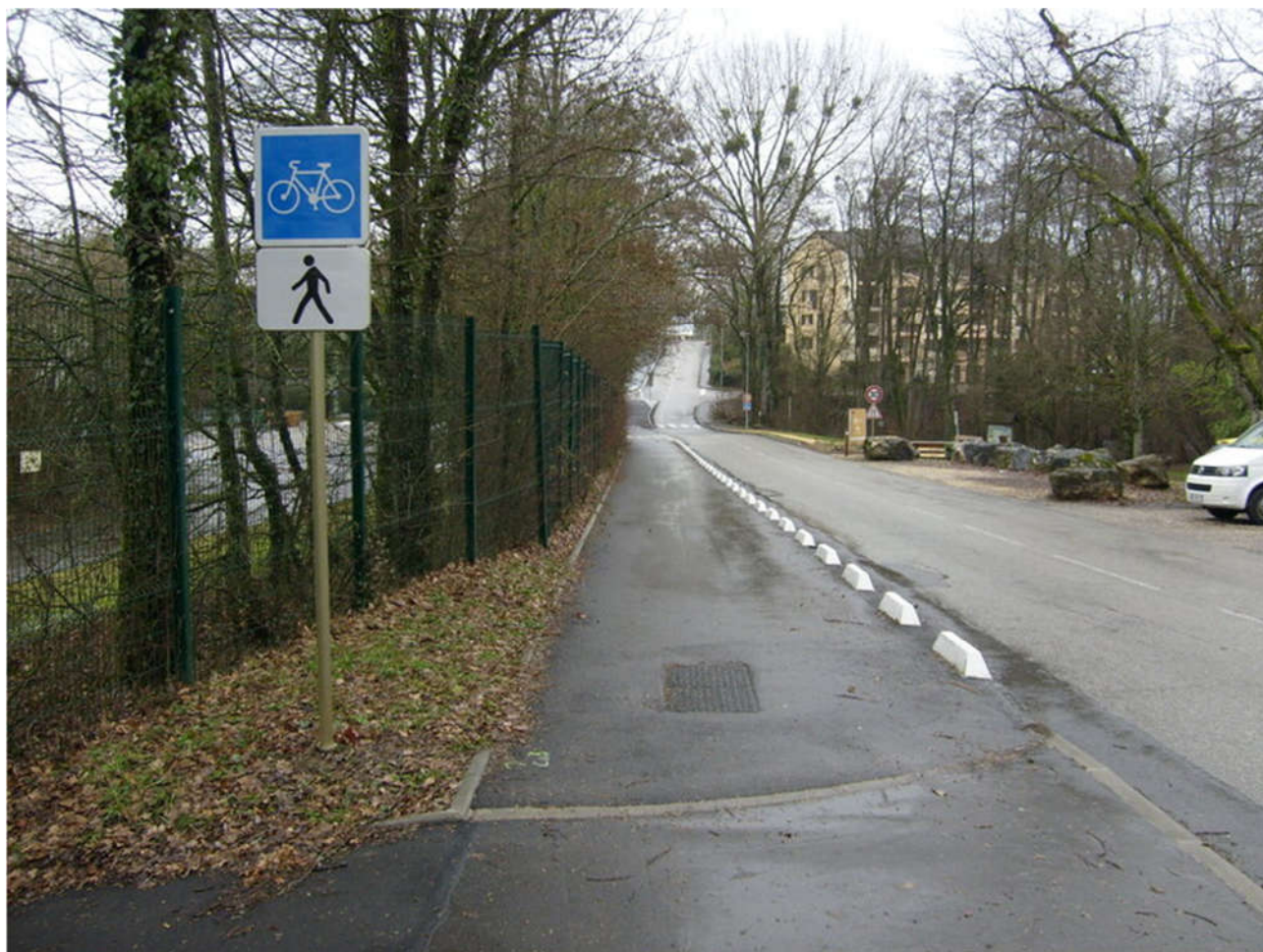
Figure 1: Le début de la voie piétons - cycle est marquée par un panneau piste cyclable, autorisé aux piétons. Il n'y a pas de panneau de fin, et pas non plus de panneau similaire pour quelqu'un circulant en sens inverse.
