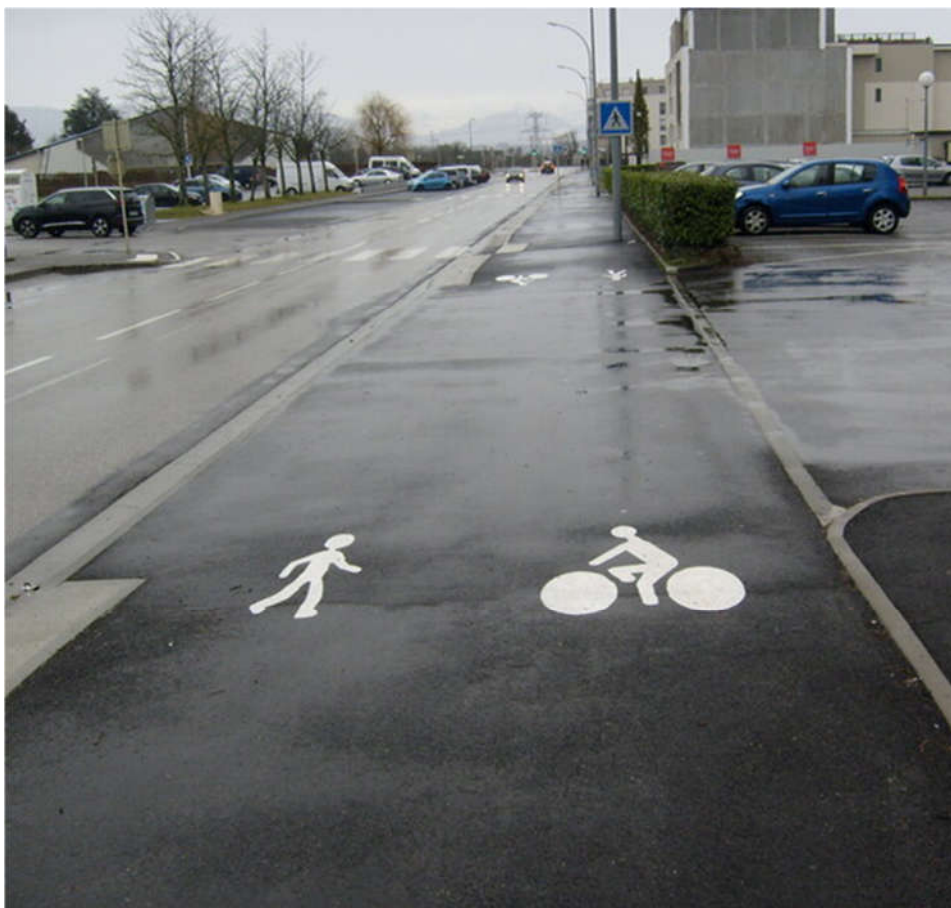
Figure 12: Ensuite, sur cette deuxième partie de l'avenue des sports, le marquage au niveau des sorties de propriétés privées n'est plus bien fait du tout. Il n'y a plus de lignes de cédez-le-passage, juste des pictos en amont. Là encore, cela manque de cohérence avec le reste du tracé, et peut entraîner des accidents. Il faudrait faire le même marquage que celui réalisé sur tout le reste du tracé. Voir figure 7 pour exemple à suivre.
