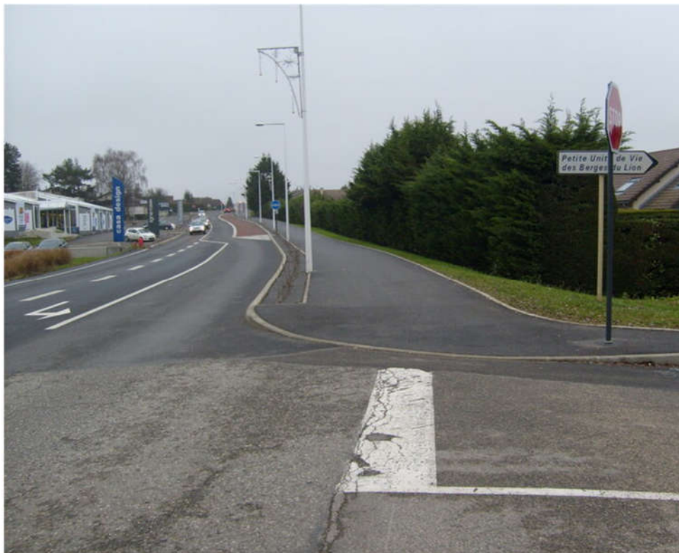
Figure 10: Fin de la voie partagée, au niveau de la rue des Berges du Lion. A défaut de signalisation verticale, il est indispensable ici de mettre des pictos indiquant que les cycles peuvent circuler sur cette chaussée, dans les deux sens (pictos cycles - piétons).
