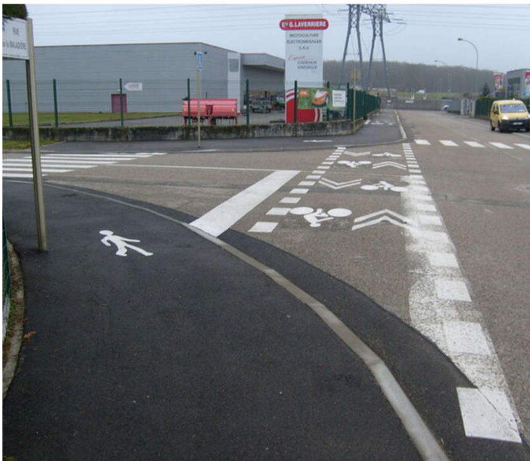
Figure 21: Intersection bien traitée comme avant, et on comprend que le trottoir partant à gauche n'est pas cyclable. Là encore, un exemple que l'on pourrait reproduire à d'autres endroits
