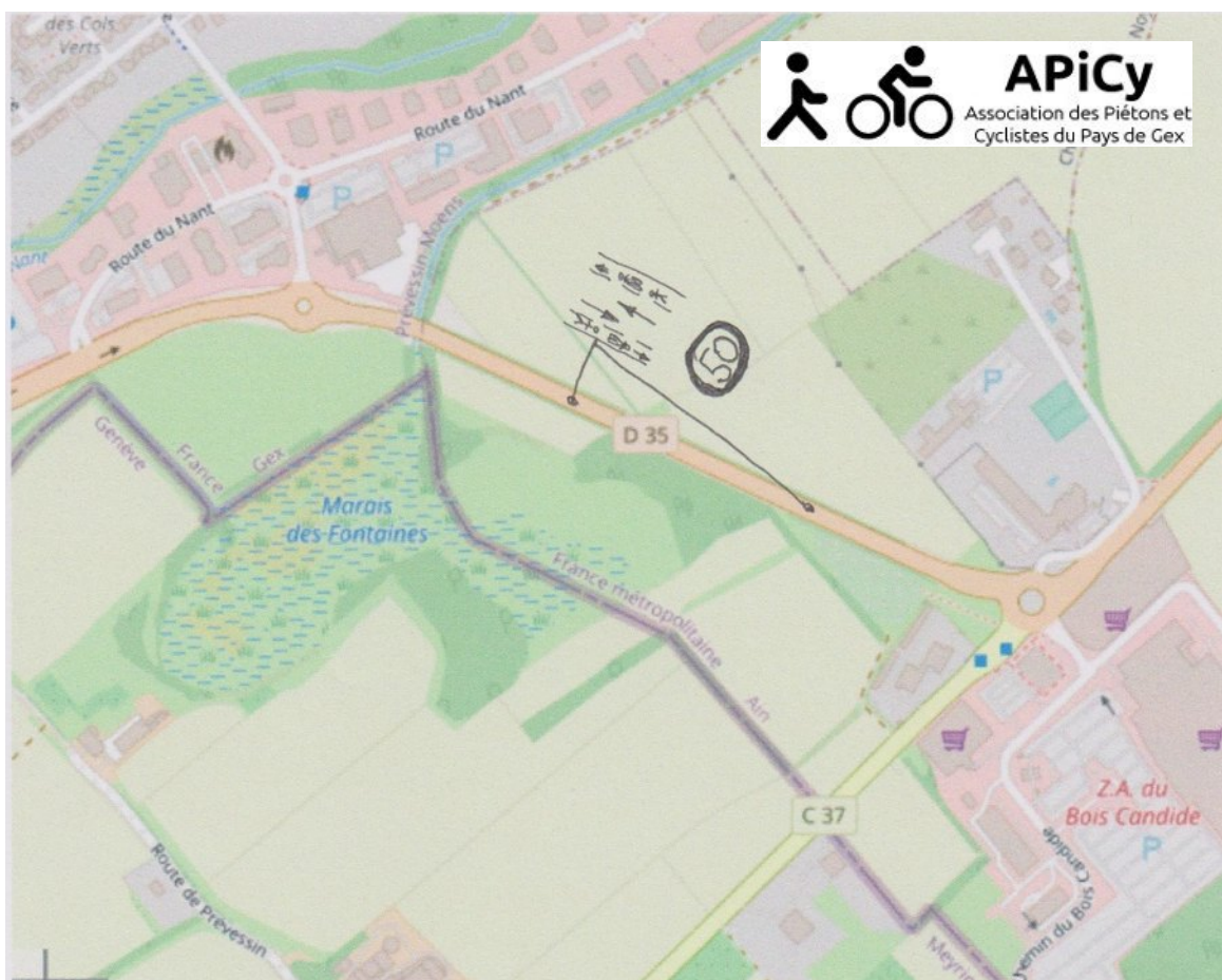
Illustration 2: Tronçon de la RD35 entre les magasins Leclerc et GammVert (Marquage de deux bandes latérales pour la mobilité douce sans le marquage médian avec la limitation de la vitesse à 50km/h)
