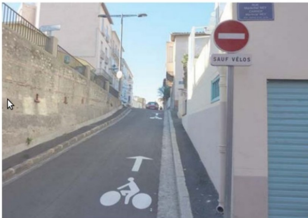
Illustration 2: Exemple de double-sens cyclable marqué au sol, permettant aux autos et cycles de bien comprendre le fonctionnement de la rue
