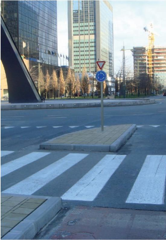
Figures 4.8 – Dans la continuité d'une piste cyclable, cet aménagement permet aux cyclistes circulant sur la piste cyclable de remonter la file jusqu'au giratoire. Cependant ils sortent du champ de vision des automobilistes à l'entrée du giratoire qui ont leur regard porté vers la gauche.
