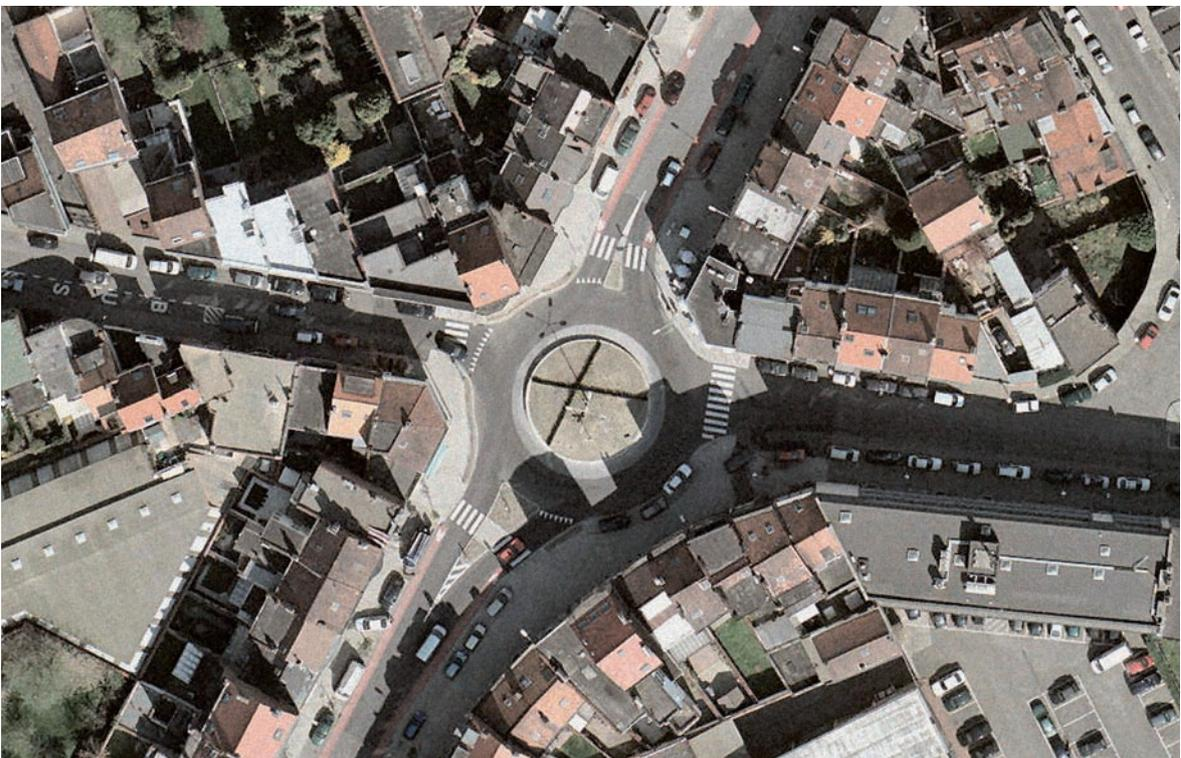
Figure 4.1 – Exemple de giratoire compact monobande ne nécessitant pas d'aménagement cyclable particulier.
