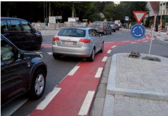
Figure 4.13 – La présence d'une piste cyclable sur la branche jusqu'au giratoire ne met pas les cyclistes à l'abri, comme illustré ci-dessus.
