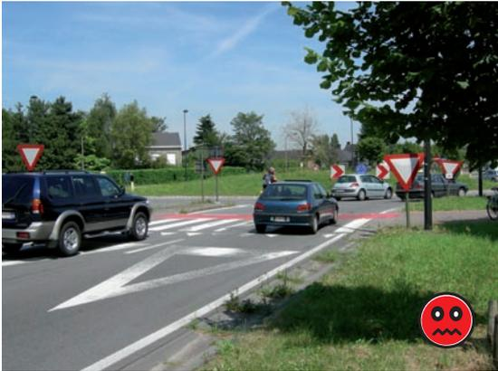
Figure 4.17 – L'aménagement d'une piste cyclable séparée prioritaire est fortement déconseillé si elle doit traverser 2 bandes de circulations dans le même sens en entrée ou sortie du giratoire.
