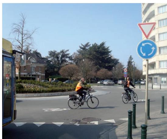
*Figure 4.5 – Le marquage de bande cyclable suggéré se fait au centre de l'anneau, à l'endroit optimal pour le cycliste. Il n'y a pas lieu de suggérer par un marquage l'emplacement optimal pour sortir du giratoire lorsque celui-ci se fait naturellement.*
