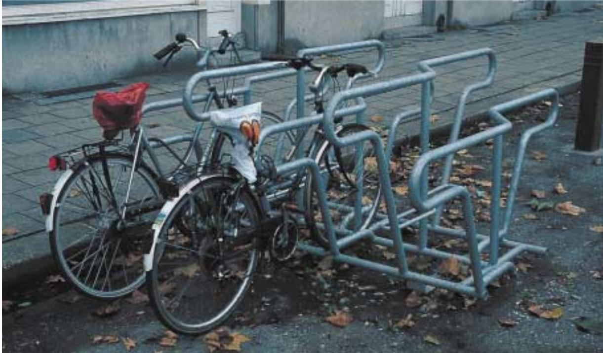
Les systèmes à plusieurs emplacements doivent former un tout, sans éléments aisément démontables. Ces systèmes ne requièrent aucun ancrage direct dans le sol.
