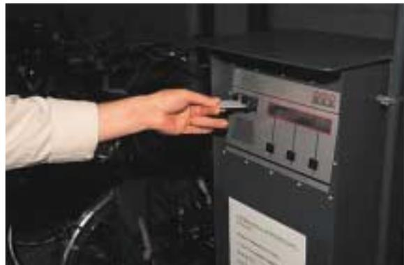
Un cadenas électronique a été intégré dans le système (hors de portée des personnes non autorisées). Ce cadenas est bloqué à l'aide d'une carte à puce. Le système ne peut être déverrouillé qu'avec la carte ayant permis de verrouiller le cadenas. Lorsque ce système est installé dans un espace fermé, cette carte permet également de donner accès au bâtiment.
