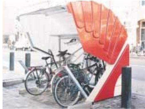
Cette cage fermée en métal ou en béton peut contenir un ou plusieurs vélos (voir photo de gauche). Un exemple de consigne destinée à contenir plusieurs vélos est le carrousel à vélos (voir photo de droite). Il s'agit d'une construction équipée d'un cadre en aluminium et d'un revêtement en vitrages synthétiques.
