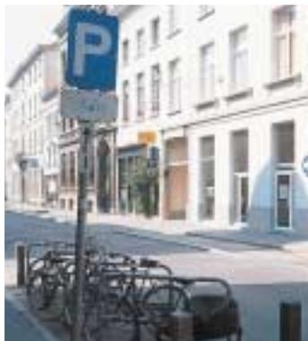
L'article 70.2.1.3<sup>o</sup>f stipule qu'une aire de stationnement pour vélos sur la chaussée est indiquée de manière réglementaire à l'aide du panneau E9a (stationnement autorisé) et du panneau additionnel M1 (vélos). Le panneau additionnel M8 (vélos et cyclomoteurs à deux roues) peut également être apposé.
