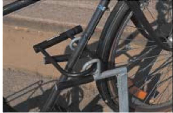
Les "pince-fourche" sont équipées d'un anneau permettant de fixer le vélo à l'aide d'un cadenas. D'autres systèmes permettent de suspendre le vélo par la roue avant ou le guidon à un crochet.
